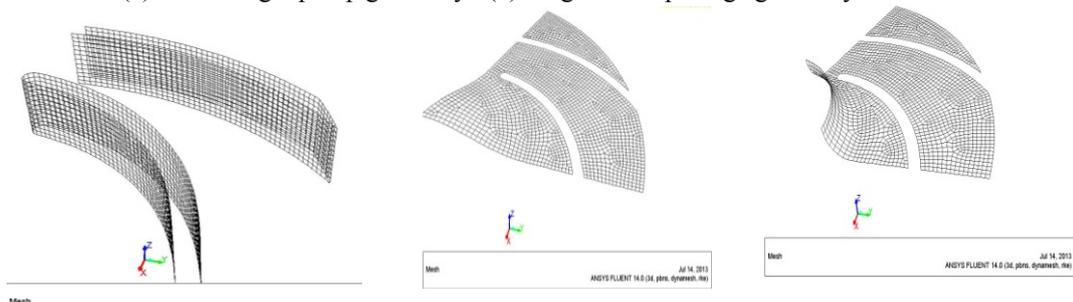
(c) Blade mesh (d) Hub Mesh (e) Shroud mesh
