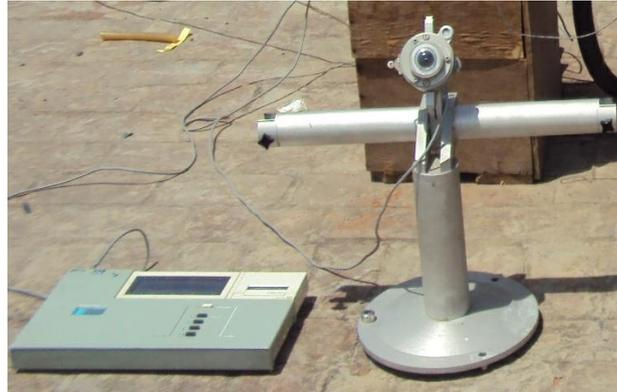
Fig. 3 Kipp and zonen pyranometer
