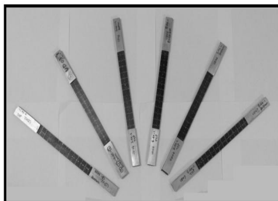
Fig. 2 Uni-Directional Longitudinal (UDL) Tensile test specimens
