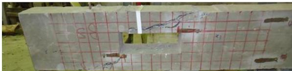
**(d) Crack pattern of the beam (B2).**
