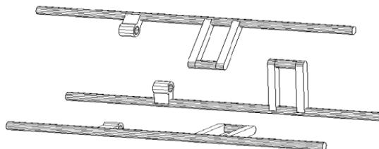
Fig. 8-Short Rocker-Arm, Rocker-Shaft and Long Rocker-Arm
