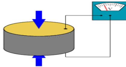
**Fig. 1 Piezoelectric Effect**
