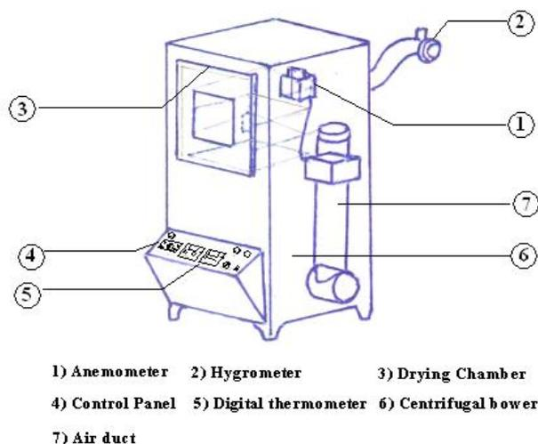
Fig. 1: Hot air dryer
