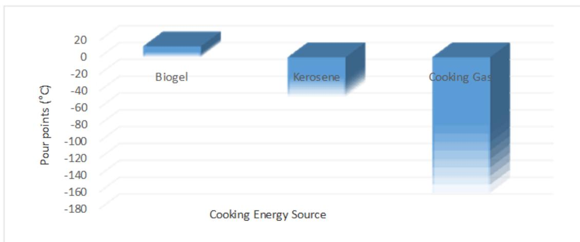
Figure 3b: Graphical representation of each cooking energy source pour point (°C)
