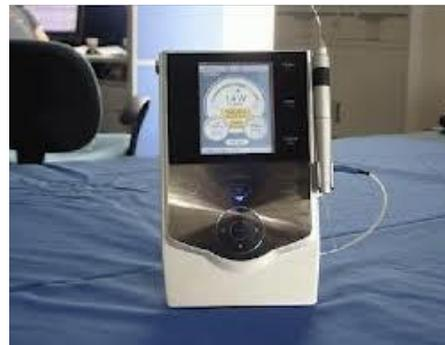
Fig.no.4: Diode laser
