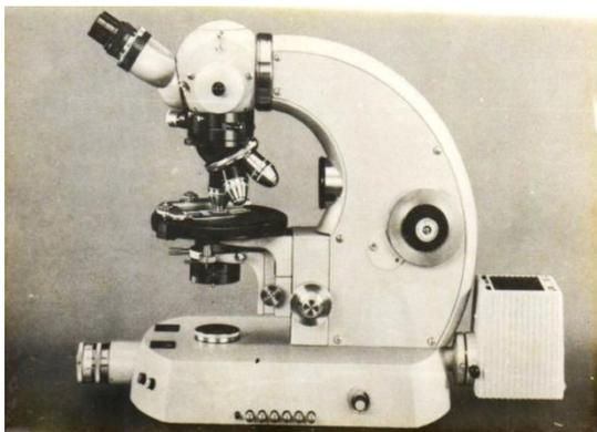
Fig. IX: ZEISS POLARIZING MICROSCOPE
