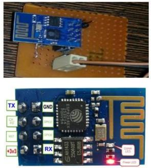
Fig 4 ESP8266 Module
