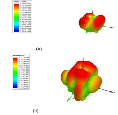
Figure (4): Total antenna numerical Gain at 9and 11 GHZ.
