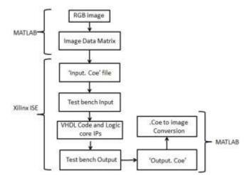
Fig. 7. Test Desgin Flow
