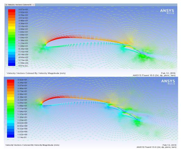
Fig 6 Velocity Gradient
