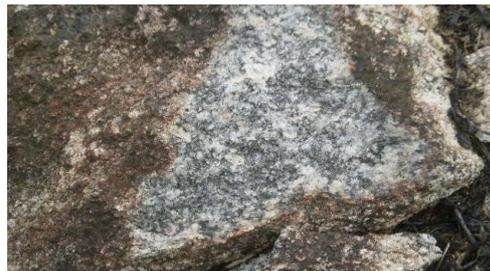
Figura 14 - Amostra de bloco de rocha granítica
