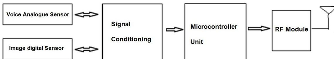
**Fig. 3 Sensor Node Block Diagram**
