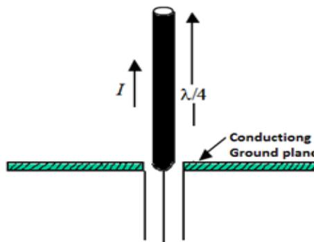
Fig. 4.  $\lambda/4$  monopole antenna
