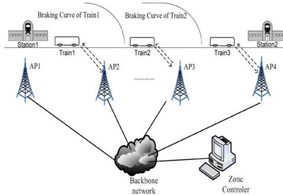
Fig: 1 ATC System Design
