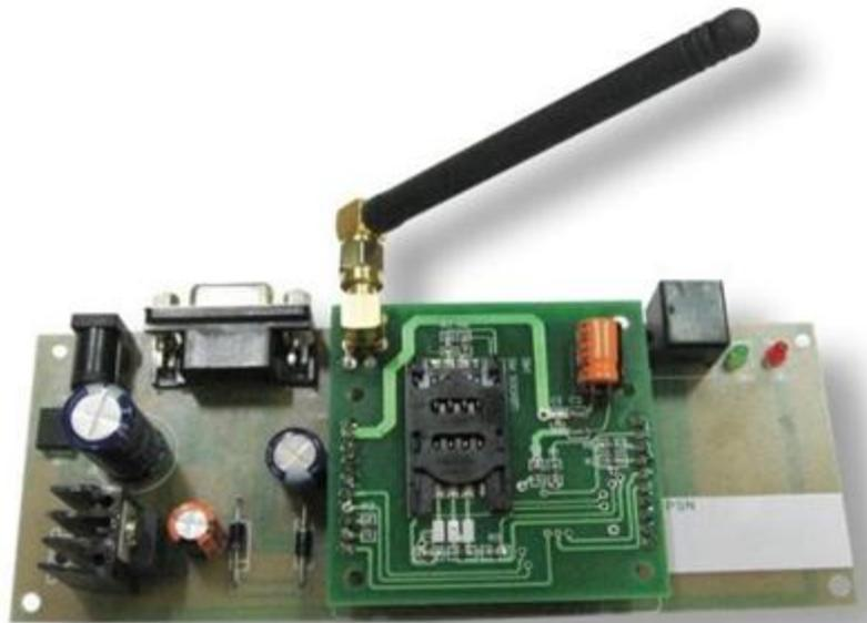
**Fig.** GSM module
