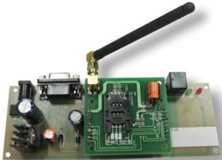
**Fig.** GSM module
